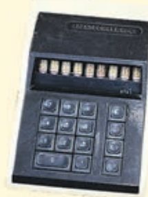
Калькулятор «Электроника СЗ-07» выпускался на заводе «Светлана» в Ленинграде. В нем было всего 15 кнопок, из-за чего некоторые функции были совмещены.
