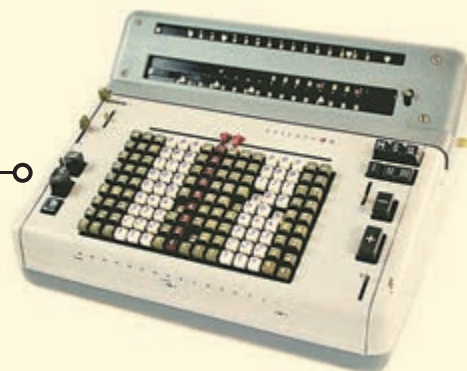
Cellatron R44 SM – электромеханический калькулятор, созданный в 1960-х годах, мог автоматически умножать и делить числа.
